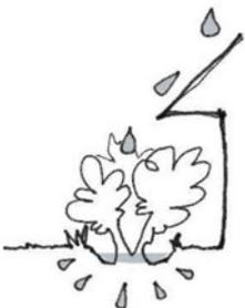
*Le processus de rétention-infiltration (dessin de gauche) se caractérise par la création dans le sol d'un espace de rétention perméable à l'eau pluviale, tel qu'un jardin de pluie, une noue etc. Cet aménagement permet à l'eau d'être retenue ponctuellement avant son infiltration dans le sol et sa restitution dans la nappe phréatique.*
